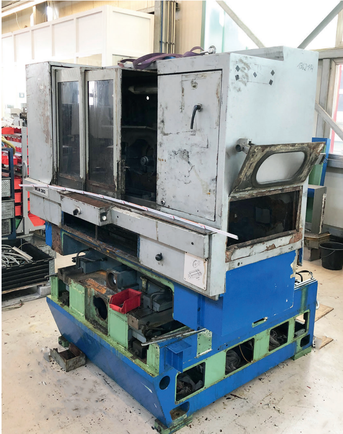
3 Bereits sehr in die Jahre gekommen war die WLM303 vor den umfangreichen Retrofit-Maßnahmen © Huttelmaier
