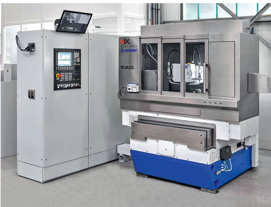
1 Die Wendt WLM303 ist nach dem Retrofit wieder hochpräzise, Elektrik und Elektronik sind auf dem neuesten Stand ©Huttelmaier
